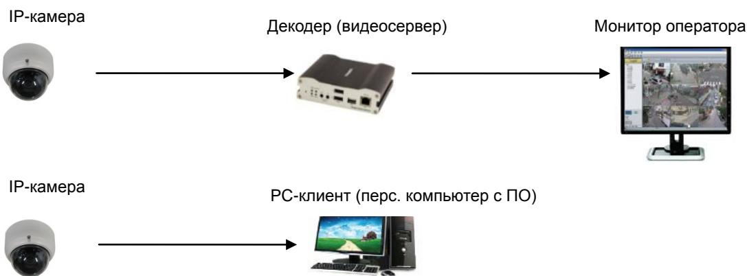
IP-камера установлена на объекте видеонаблюдения и передаёт видеоданные. Персональный компьютер с установленным ПО или декодер установлены в центре видеонаблюдения и принимают и отображают видеоданные на аналоговом мониторе оператора. Аудиоданные и данные телеметрии передаются в обоих направлениях.
