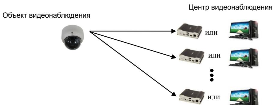
При такой конфигурации, объект видеонаблюдения может просматриваться из нескольких центров видеонаблюдения. Несмотря на то, что к одной IP-камере могут подключаться до 64 клиентов одновременно, пропускная способность сети ограничивает число одновременных подключений. Функционально, ПО TVMS полностью заменяет декодер.
