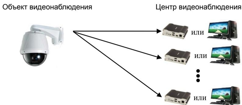
При такой конфигурации, объект видеонаблюдения может просматриваться из нескольких центров видеонаблюдения. Несмотря на то, что к одной IP-камере могут подключаться до 64 клиентов
