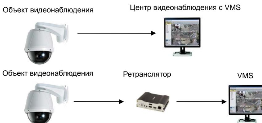
ПО VMS (Video Management System) – это программа на базе ОС семейства Microsoft Windows, которая позволяет осуществлять мониторинг, контроль, настройку и запись событий, видео и аудио данных в реальном времени нескольких IP-камер или видеосерверов. Для получения более подробной информации, прочтите инструкцию по эксплуатации ПО VMS.
