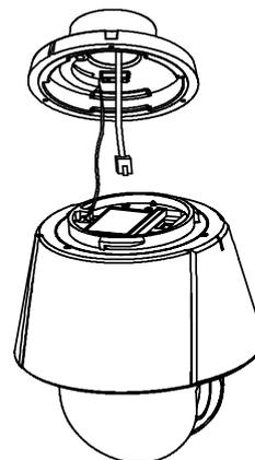
③ Найдите две вспомогательные метки: одну на корпусе камеры и одну на кронштейне. Расположите корпус камеры таким образом, чтобы обе метки были совмещены так, как показано на рисунке. Прикрепите корпус камеры к кронштейну, используя 4 винта и ключ, которые поставляются в комплекте с камерой (типа Torx M4X18). Убедитесь, что винты жёстко привинчены и обеспечивают водонепроницаемость.
