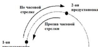
В случае, если начальная и конечная предустановки совпадают, камера поворачивается на 360 градусов по часовой стрелке, а затем на 360 градусов против часовой стрелки.
