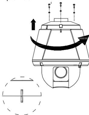
④ Закрепите крышку купола к камере и удалите с неё защитную плёнку.
