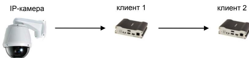
Видео и аудио данные могут быть ретранслированы от одного клиента другому. Такой режим используется в случае ограниченной ширины канала, связывающего IP-камеру с центром видеонаблюдения (клиент1) – он позволяет ретранслировать данные от этой камеры множеству другим клиентам, не используя ограниченный канал связи.
