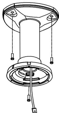
② Подвесьте корпус камеры к кронштейну поддерживающим тросиком для предотвращения падения камеры и подключите кабели.
