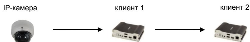
Видео и аудио данные могут быть ретранслированы от одного клиента другому. Такой режим используется в случае ограниченной ширины канала, связывающего IP-камеру с центром видеонаблюдения (клиент1) – он позволяет ретранслировать данные от этой камеры множеству другим клиентам, не используя ограниченный канал связи.
