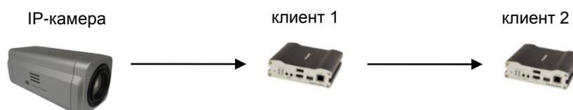
Видео и аудио данные могут быть ретранслированы от одного клиента другому. Такой режим используется в случае ограниченной ширины канала, связывающего IP-камеру с центром видеонаблюдения (клиент1) – он позволяет ретранслировать данные от этой камеры множеству другим клиентам, не используя ограниченный канал связи.
