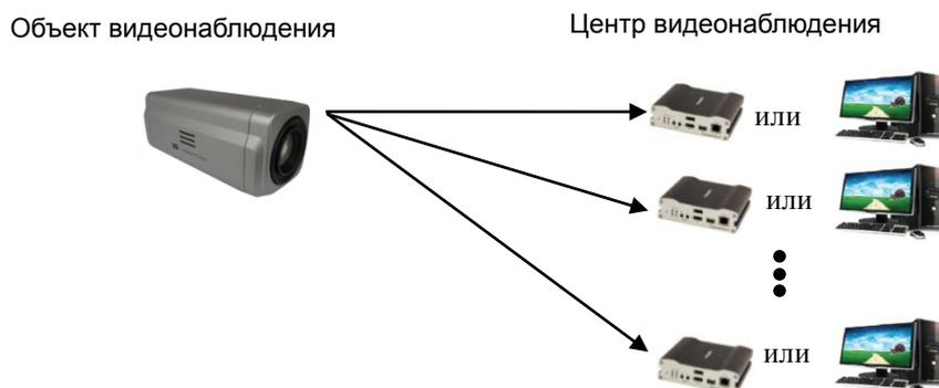
При такой конфигурации, объект видеонаблюдения может просматриваться из нескольких центров видеонаблюдения. Несмотря на то, что к одной IP-камере могут подключаться до 64 клиентов одновременно, пропускная способность сети ограничивает число одновременных подключений. Функционально, ПО TVMS полностью заменяет декодер.
